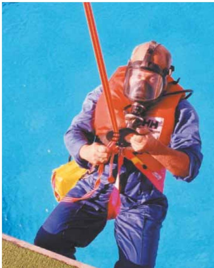
Зapatентованное персональное устройство управления спуском Donut было разработано после трагедии на нефтяной платформе Piper Alpha в сотрудничестве с органами контроля, надзора и регулирования Великобритании и разработчиками нефтегазовых месторождений в Северном море и принято в качестве отраслевого стандарта для устройств аварийного спуска с объектов морской добычи и транспортировки нефти и газа.
